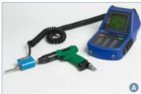
Configurazione di misura con trasduttore rotativo ed avvitatore pneumatico Fiam ad arresto automatico ed istantaneo dell'aria
