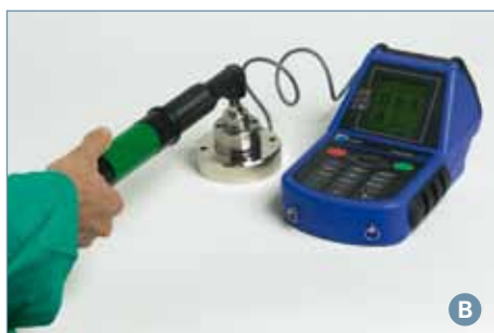
Configurazione di misura con trasduttore statico ed avvitatore pneumatico Fiam ad arresto automatico ed istantaneo dell'aria
