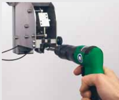
La foto illustra il momento del prelievo vite con utensile pneumatico Fiam.
