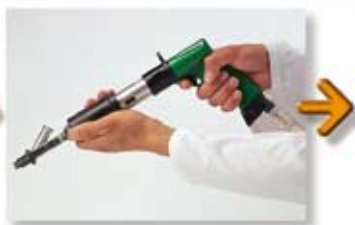
Caricamento semiautomatico (manuale) della vite sulla testa dell'avvitatore
