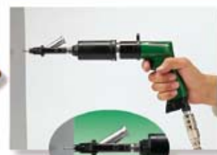
Posizionamento della vite in zona avvitatura
