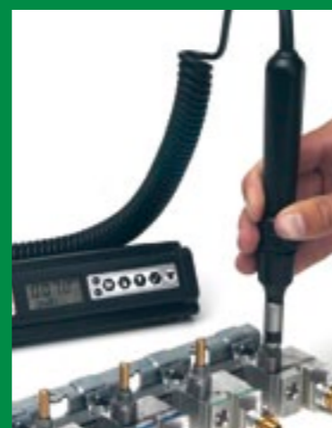
Esempio di misurazione statica con cacciavite dinamometrico digitale FIAM, modello TSD.
