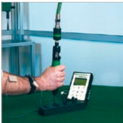
Avvitatore personalizzato con dispositivo di aspirazione viti utile in presenza di viti INOX non magnetizzabili.
