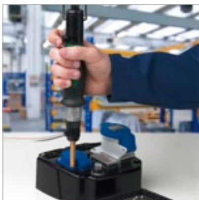
Avvitatore personalizzato con dispositivo di aspirazione viti utile in presenza di viti INOX non magnetizzabili.
