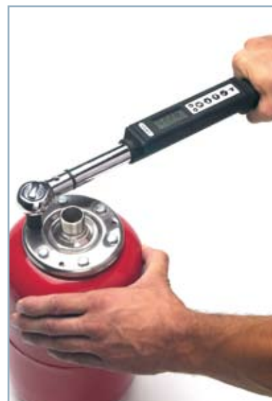
esempio di misurazione statica con chiave dinamometrica digitale TWD
