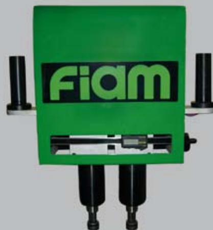
Multiplo a interasse variabile con dispositivo ottico di misurazione della distanza tra i fusi
