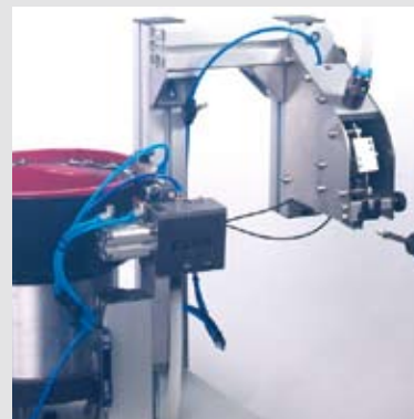
La foto illustra il gruppo di alimentazione vite con il dispositivo per il prelievo della vite
