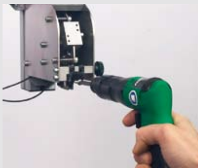
La foto illustra il momento del prelievo automatico vite con utensile pneumatico Fiam.
