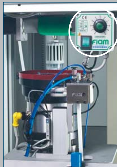
La foto illustra una configurazione applicativa del controller elettronico Fiam
