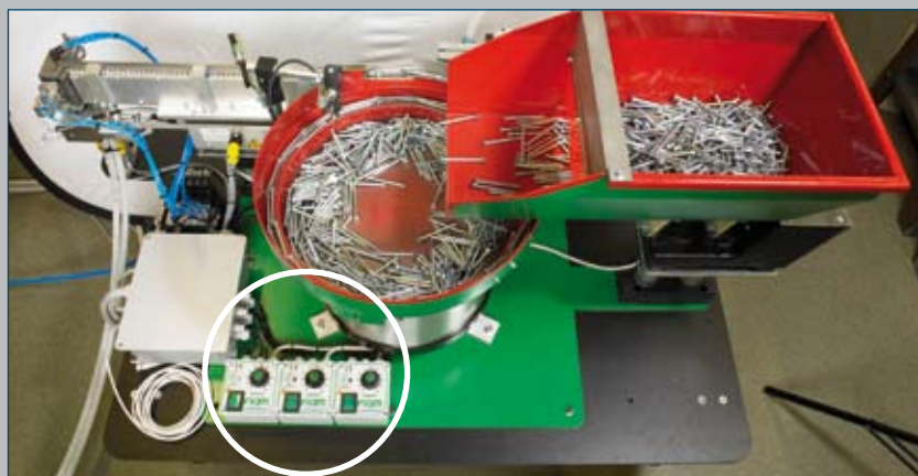
La foto illustra una configurazione applicativa del controller elettronico Fiam
