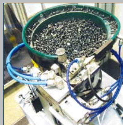
La foto illustra una configurazione applicativa di un alimentatore ALC Fiam
