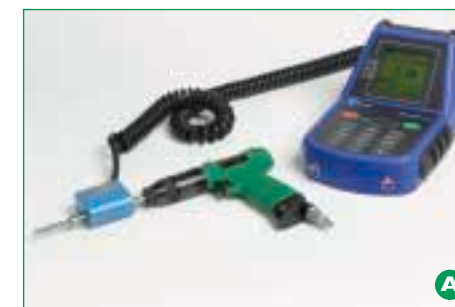
A Configurazione di misura con trasduttore rotativo ed avvitatore pneumatico Fiam ad arresto automatico ed istantaneo dell'aria.
